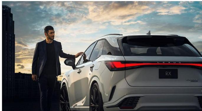
Para conseguir una presencia más audaz, los diseñadores de Lexus se decantaron por una postura más esbelta, de delante a atrás, extendiendo el capó, alargando la distancia entre ejes 60 mm y rebajando el techo 10mm. El característico pilar posterior negro (el llamado "techo flotante" de Lexus) tiene ahora un aspecto más tridimensional que confiere al vehículo una sensación de coupé, mientras que la línea de carácter fluida y las grandes llantas de 53,3 cm (21") otorgan al RX un mayor dinamismo.
