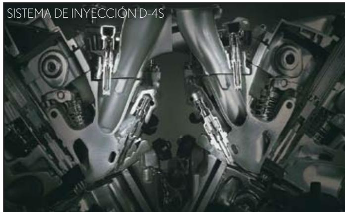
Los inyectores indirectos del sistema D-4S emplean 12 orificios para inyectar combustible a una presión máxima de 4 bares, mientras que los inyectores directos ofrecen una doble ranura rectangular de 0,52 x 0,13 mm que genera un doble patrón de inyección de ventilador para producir la mezcla de aire y combustible más homogénea posible.
